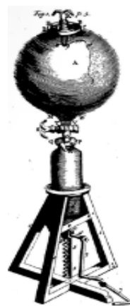
Fig. 4. La bomba de aire.. Fuente: Boyle (1682).
